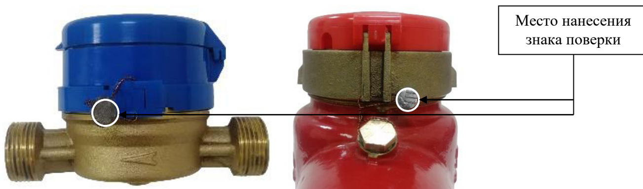
Р и с у н о к 3 – Схема пломбировки от несанкционированного доступа, обозначение места нанесения знака поверки
