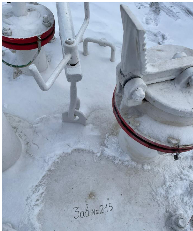
Рисунок 1 –Место нанесения заводского номера
