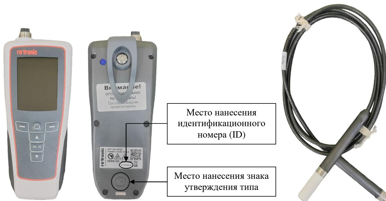
Р и с у н о к 1 – Общий вид гигрометров с указанием мест нанесения знака утверждения типа и идентификационного номера (ID)
