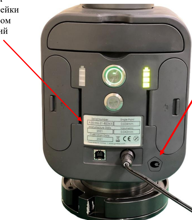
Рисунок 6 – Места нанесения маркировочной наклейки с заводским номером и знака утверждения типа средства измерений
