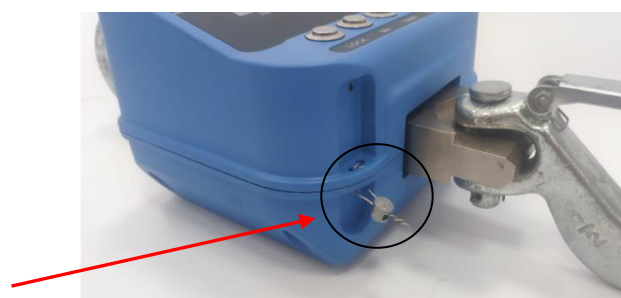
Рисунок 4 – Схема пломбировки от несанкционированного доступа и место нанесения знака поверки
