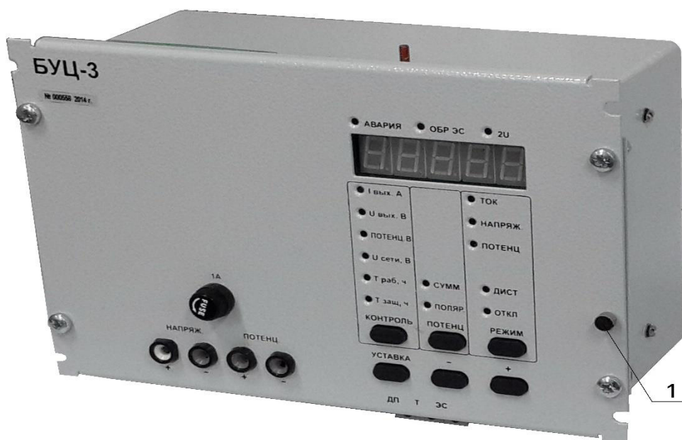
1 - Место нанесения знака поверки Рисунок 1 - Общий вид блока БУЦ-3
