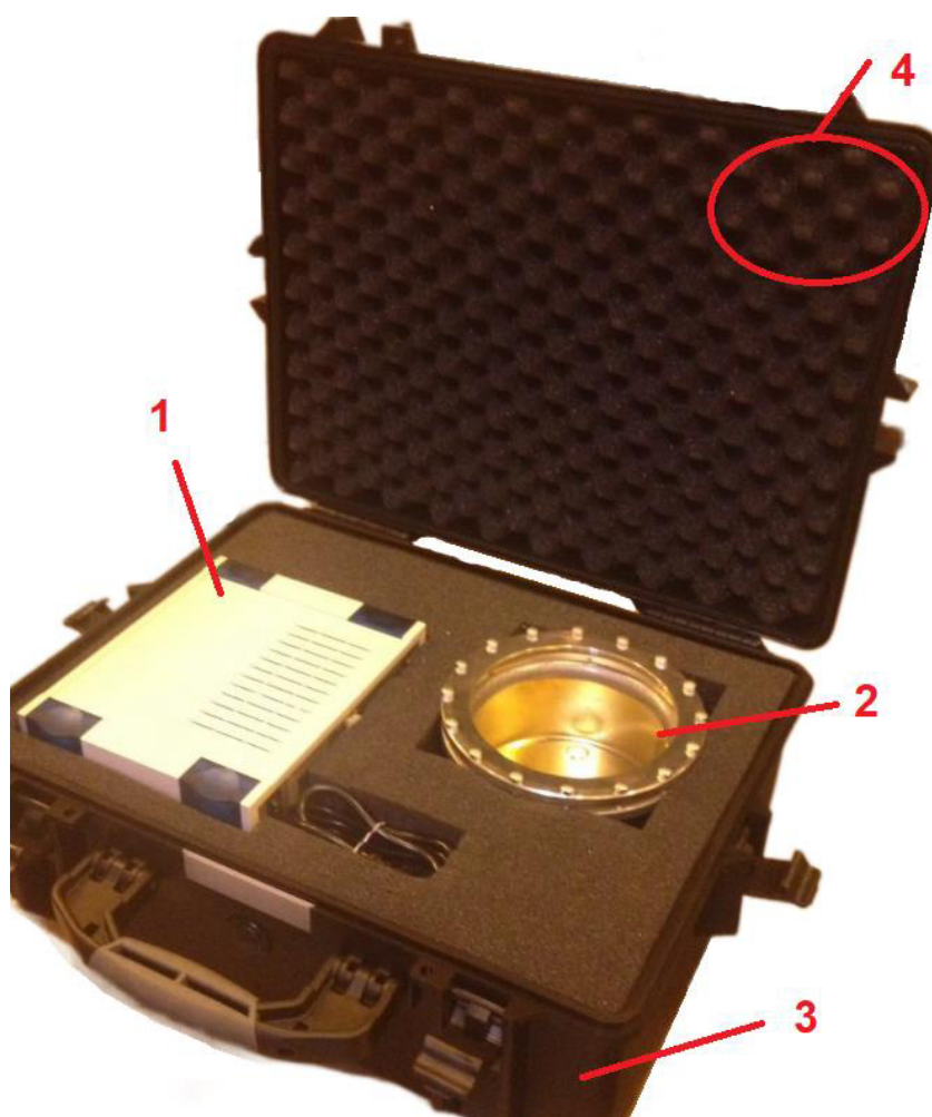
Рисунок 1 – Общий вид комплексов поверочных портативных КПП-1 1 - барометр, 2 - герметичная камера давления (бароблок), 3 - кейс для хранения и перевозки, 4 - место нанесения заводского номера и знака утверждения типа (на пластике кейса под подкладкой)
