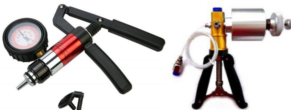
Рисунок 2 – Устройства задания и поддержания давления ЛАНИТ ПМП2 (слева) и ГИК РНР2 (справа)
