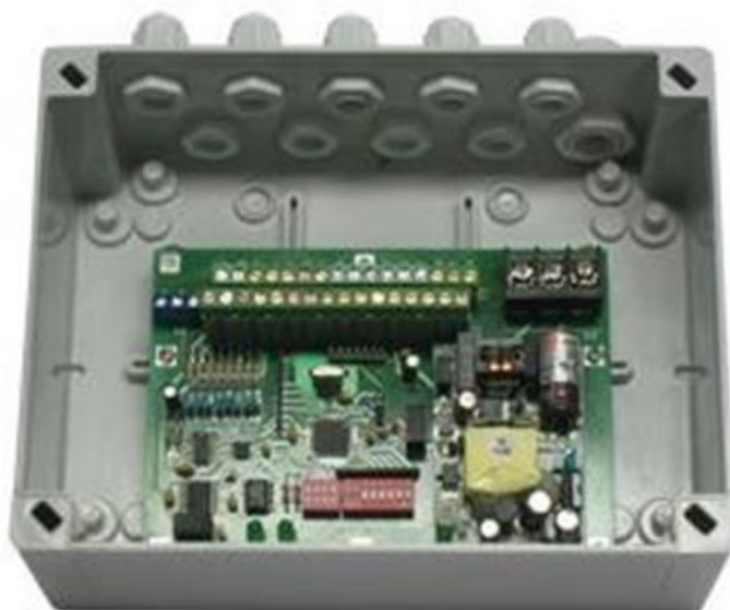
Рисунок 3 – Общий вид блока опроса термоподвесок БОТ-01
