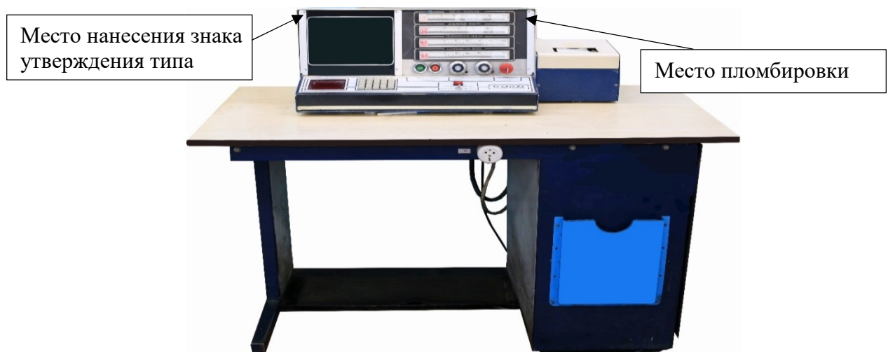
Рисунок 1 – Общий вид систем, место нанесения знака утверждения типа и место пломбировки от несанкционированного доступа
