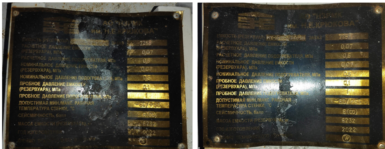
Рисунок 1 – Маркировочные таблички резервуаров
