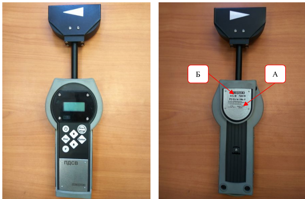
Рисунок 1 – Общий вид измерителя с встроенной головкой в корпусе тип 1; А – место нанесения заводского номера; Б – нанесения знака утверждения типа
