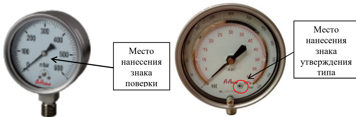
Рисунок 4 – Места нанесения на манометры знака поверки и знака утверждения типа средства измерений
