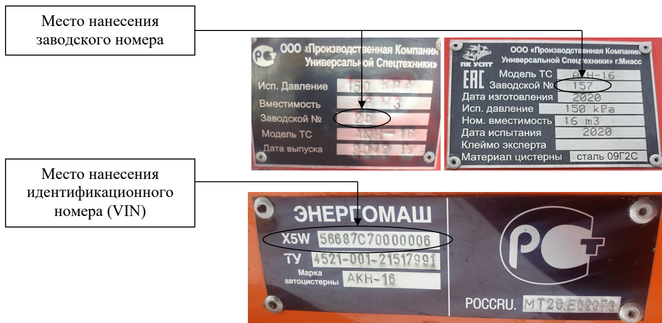
Р и с у н о к 4 – Места нанесения заводских номеров и идентификационных номеров (VIN)
