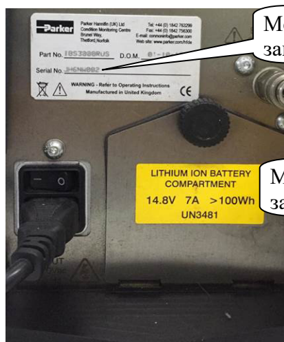
Рисунок 9 – Место нанесения заводского номера модификаций iCountBS и iCountBS2
