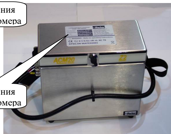
Рисунок 8 – Место нанесения заводского номера модификации ACM20 Z2
