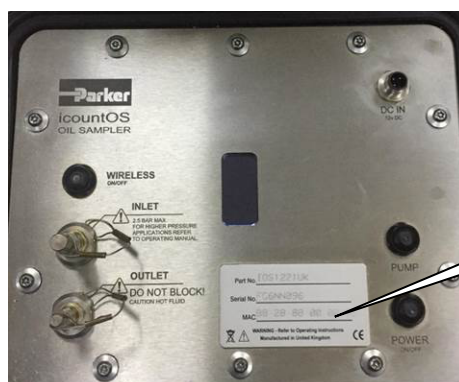
Рисунок 11 – Место нанесения заводского номера модификации iCountOS
