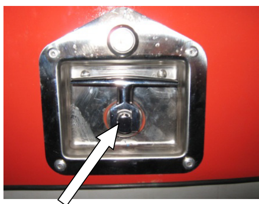
Рисунок 4 – Запорный механизм крышки заливной горловины ПЦ и ППЦ
