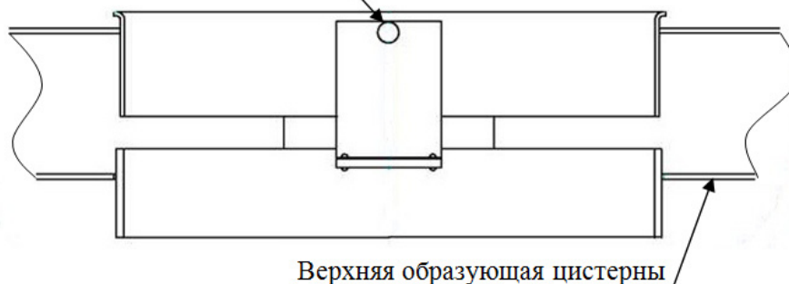
Рисунок 4 – Схема пломбировки от несанкционированного изменения положения указателя уровня налива, обозначение места нанесения знака поверки
