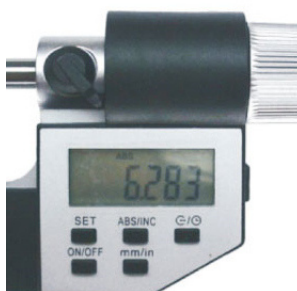
Рисунок 16 – Общий вид цифрового отсчетного устройства тип 5
