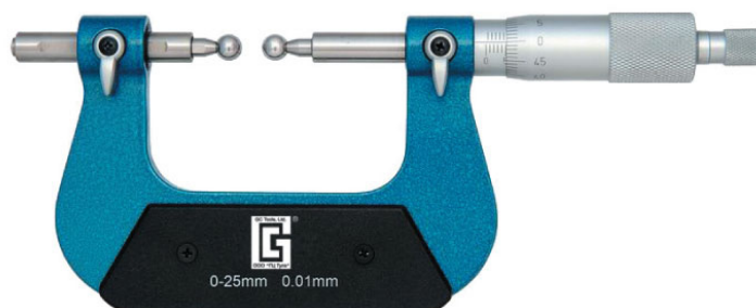
Рисунок 12 – Общий вид микрометров специальных МКД17 тип I.
