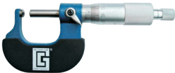
Рисунок 1 – Общий вид микрометров специальных МКД1
