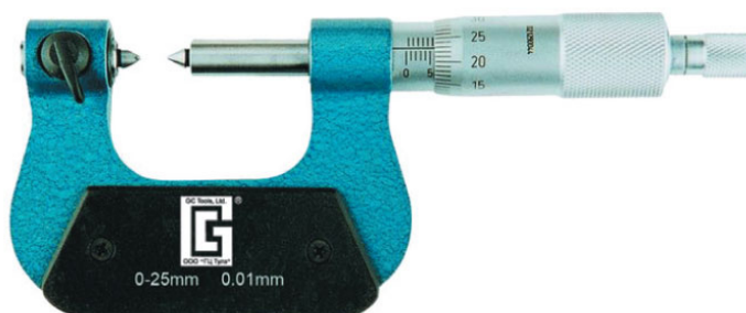
Рисунок 14 – Общий вид микрометров специальных МКД18
