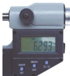
Рисунок 15 – Общий вид цифрового отсчетного устройства тип 3
