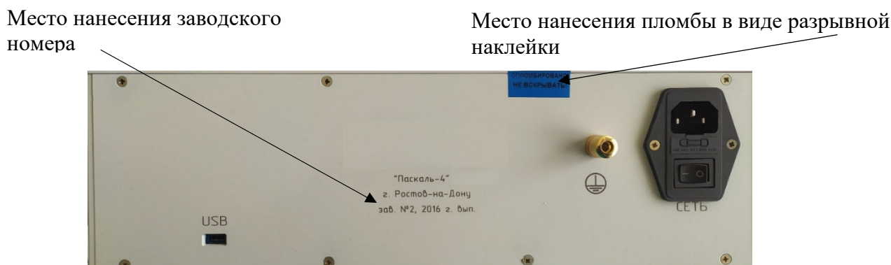
Рисунок 2 - Задняя панель АК с указанием мест пломбировки (разрывной наклейки) и заводского номера
