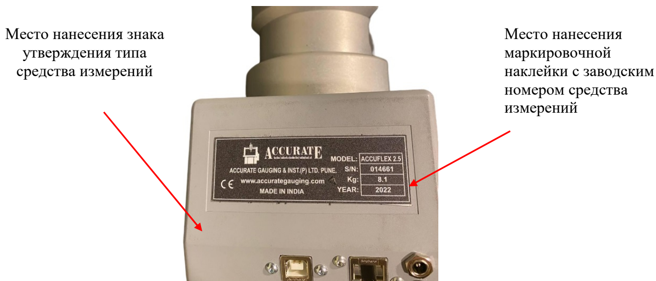
Рисунок 3 – Места нанесения маркировочной наклейки с заводским номером и знака утверждения типа средства измерений
