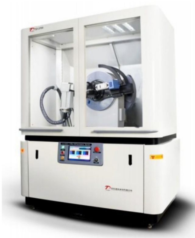
Рисунок 1 - Общий вид дифрактометра модификации TD-3700
