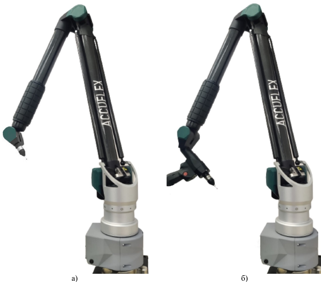
Рисунок 1 – Машины координатно-измерительные портативные Accurate Accuflex: а) Accuflex 6 axes с 6 осями вращения; б) Accuflex 7 axes с 7 осями вращения
