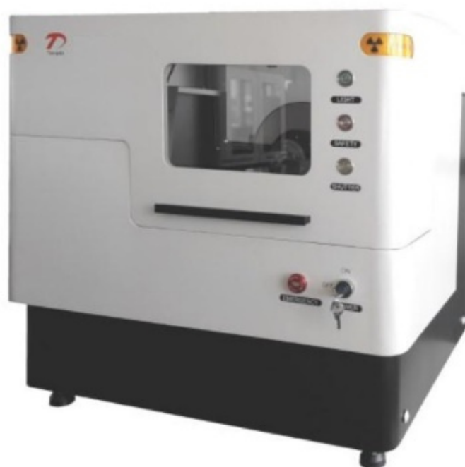
Рисунок 2 - Общий вид дифрактометра модификации TDM-20 с открытым защитным корпусом
