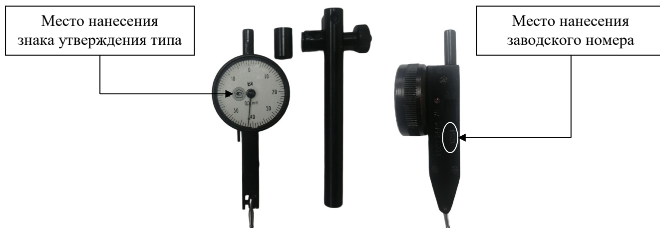
Рисунок 1 – Общий вид индикаторов ИРБ с указанием мест нанесения заводского номера и знака утверждения типа
