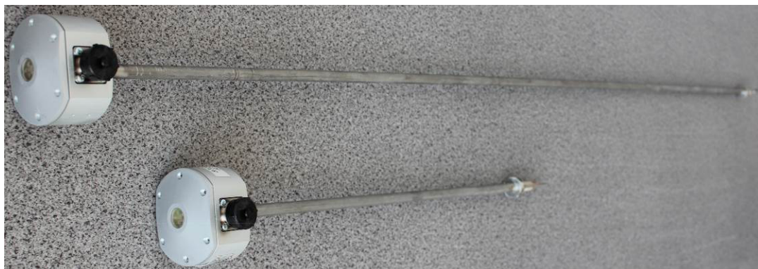
Рисунок 3 – Общий вид датчиков давления серии Кедр ДДИ
