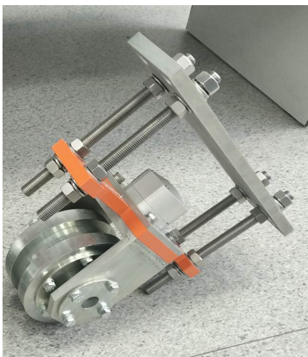
Рисунок 2 – Общий вид датчиков натяжения цепи серии Кедр ДНЦ
