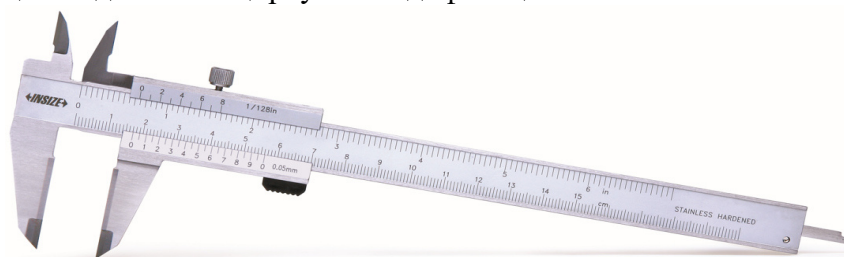
Рисунок 4 – Общий вид штангенциркулей модификации 1238 исполнения 1502, 2002, 3002, 150, 200, 300 (губки для наружных и внутренних измерений оснащены твердосплавными вставками)
