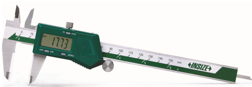
Рисунок 56 – Общий вид штангенциркулей модификации 1193 исполнения 150, 200, 300, 150WL, 200WL, 300WL (губки для наружных измерений оснащены керамическими вставками)
