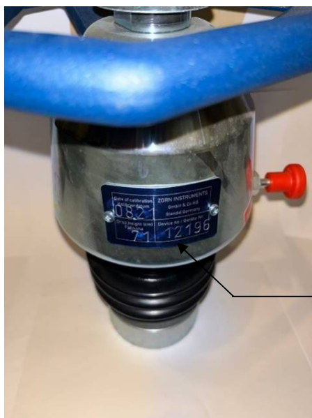
Рисунок 7 - Место нанесения заводского номера на нагрузочном приспособлении
