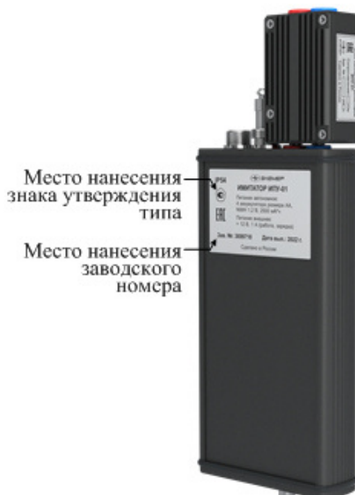
Рисунок 2 – Место нанесения знака утверждения типа, заводского номера
