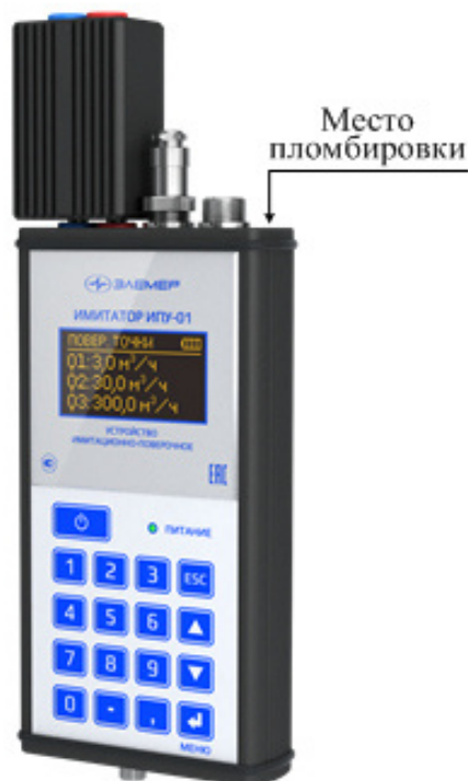
Рисунок 3 – Схема пломбировки от несанкционированного доступа ИПУ-01
