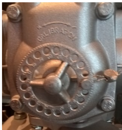
Рисунок 8 – Пломбирование счётчика жидкости объёмного типа
