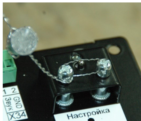
Рисунок 10 – Пломбирование фиксирующей планки блока индикации и управления «КВАНТ»
