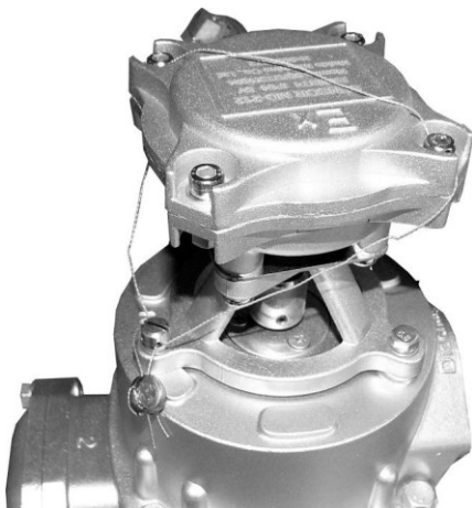
Рисунок 9 – Пломбирование генератора импульсов
