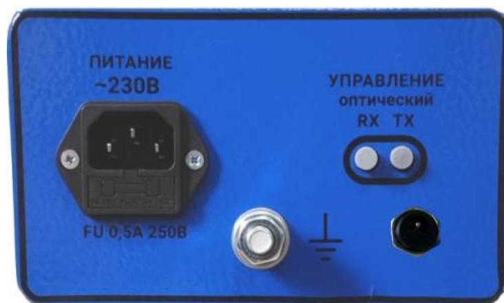
Рисунок 7 – Блок измерительный, вид сзади (с дополнительным разъемом питания 12 В)
