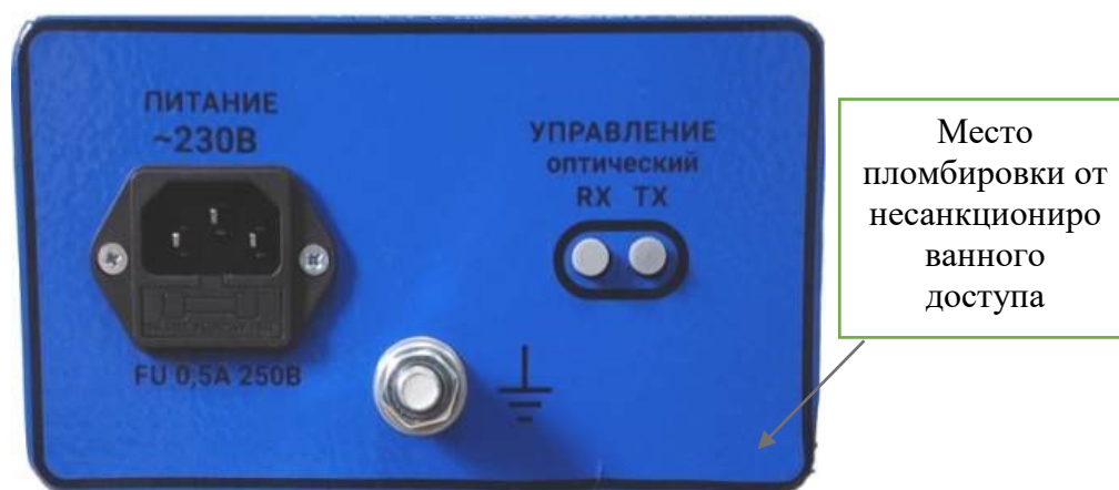
Рисунок 6 – Блок измерительный, вид сзади (без дополнительного разъема питания 12 В)
