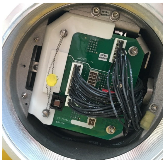
Рисунок 2в – Место установки пломбы, несущей знак поверки – пломбировка аппаратной защиты на материнской плате.
