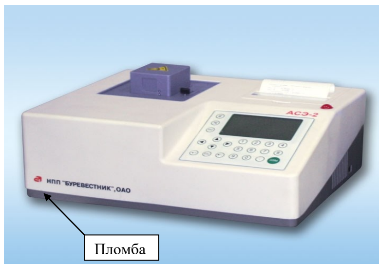
Рисунок 1 - Общий вид анализатора серы рентгеновского энергодисперсионного АЭС-2 с указанием места пломбировки от несанкционированного доступа
