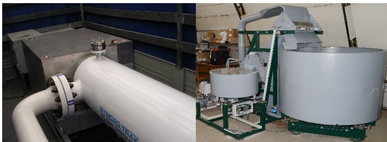
Рисунок 2 – Общий вид установок поверочных автоматизированных УПРС+
