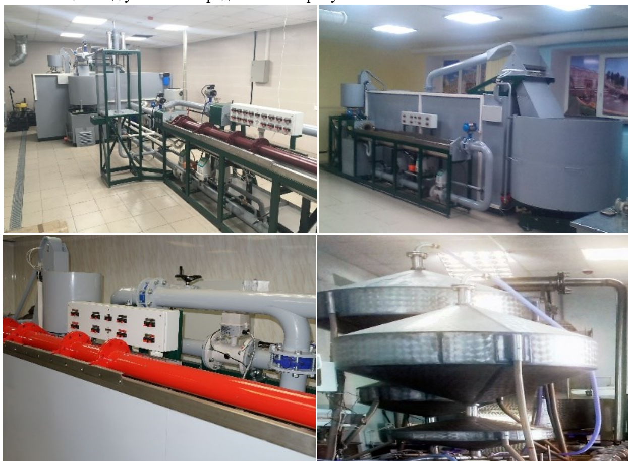
Рисунок 1 – Общий вид установок поверочных автоматизированных УПРС+
