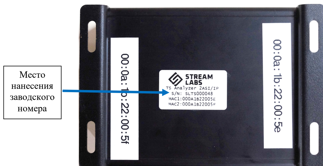
Рисунок 2 – Анализатор, вид сзади с указанием места нанесения заводского номера
