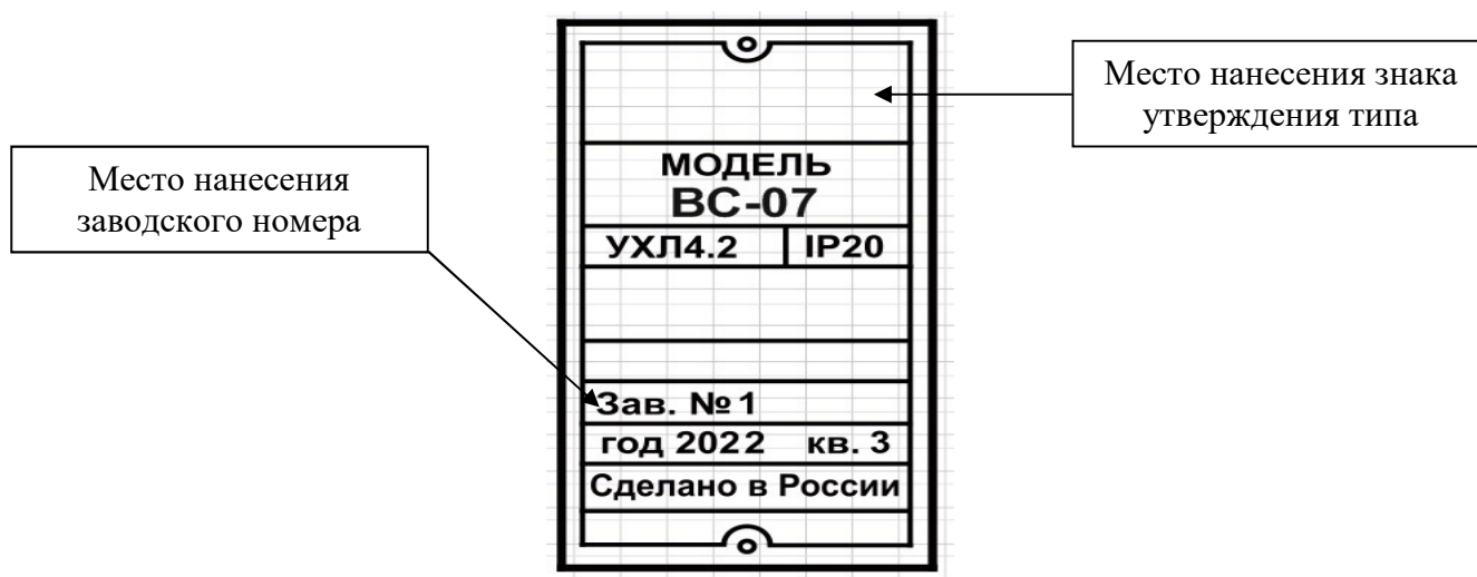
Рисунок 3 – Обозначение места нанесения знака утверждения типа и заводского номера
