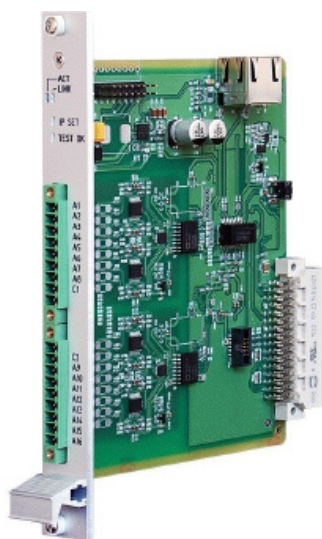
Рисунок 3 - Модули аналогового ввода лов тока и напряжения AI16I-XX и AI16U-XX
