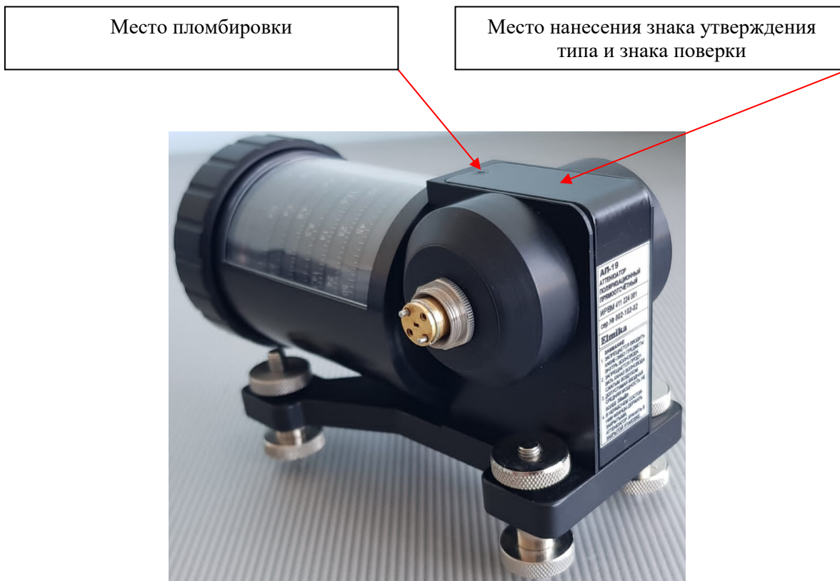
Рисунок 2 – Внешний вид аттенюаторов с обозначением мест нанесения знака утверждения типа, знака поверки и пломбировки
