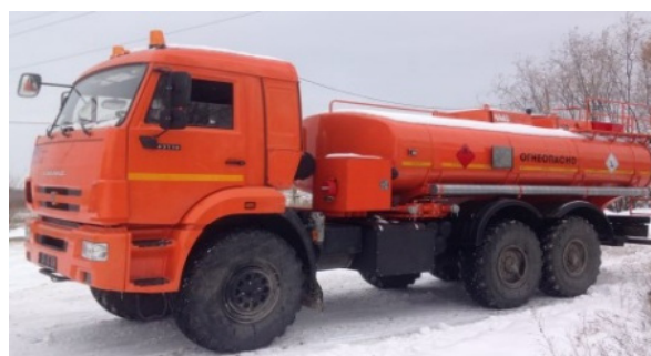
Рисунок 2 – Общий вид АТЗ с двумя секциями
