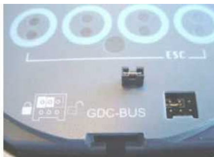
Рисунок 4 - Дисплей преобразователя сигналов IFC300 C/F. Защита от несанкционированного доступа
