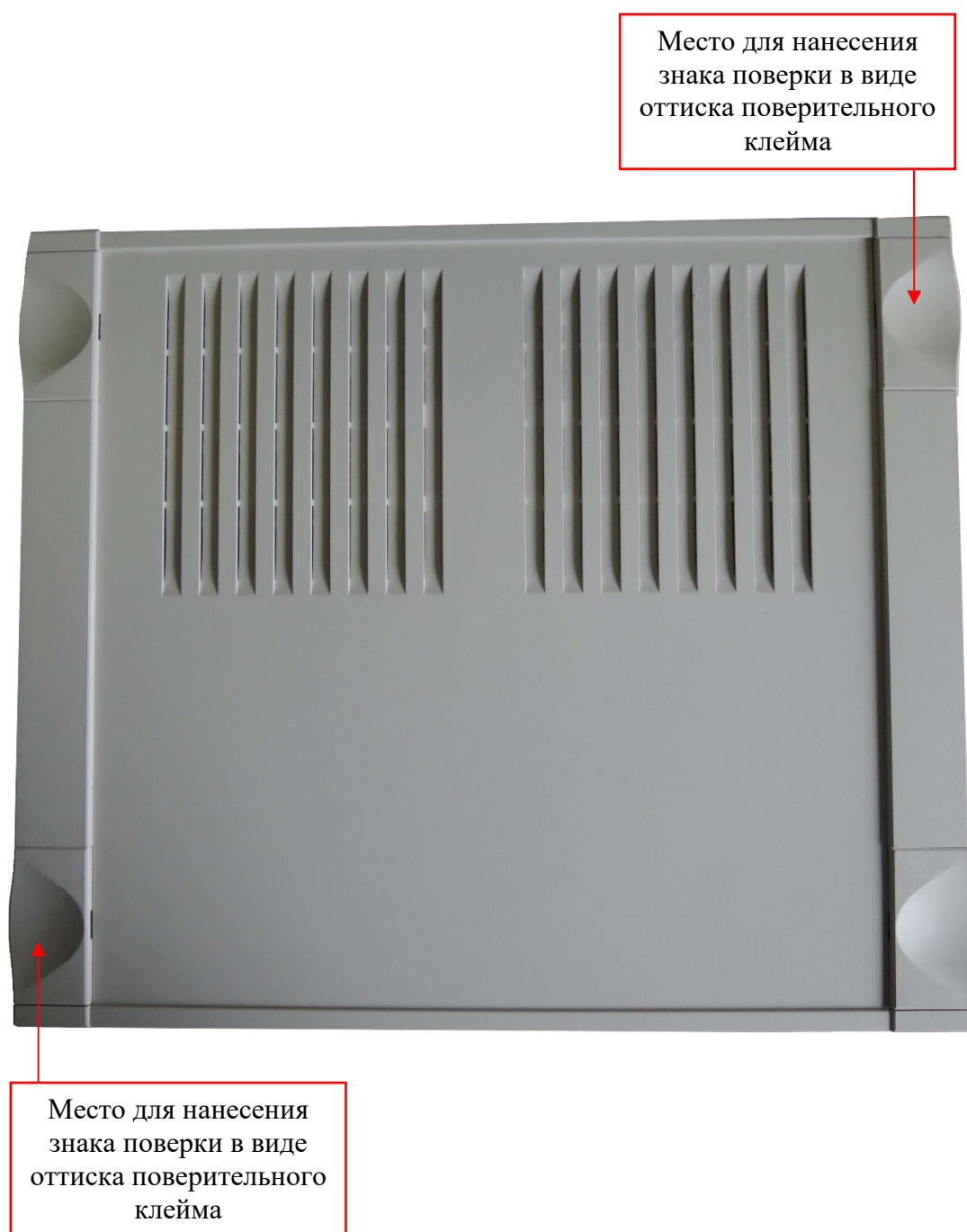
Рисунок 4 – Фотография общего вида генератора с указанием мест нанесения знаков поверки в виде отиска поверительного клейма, нанесенного на мастичные пломбы, закрывающие доступ к винтам крепления верхней крышки корпуса генератора
