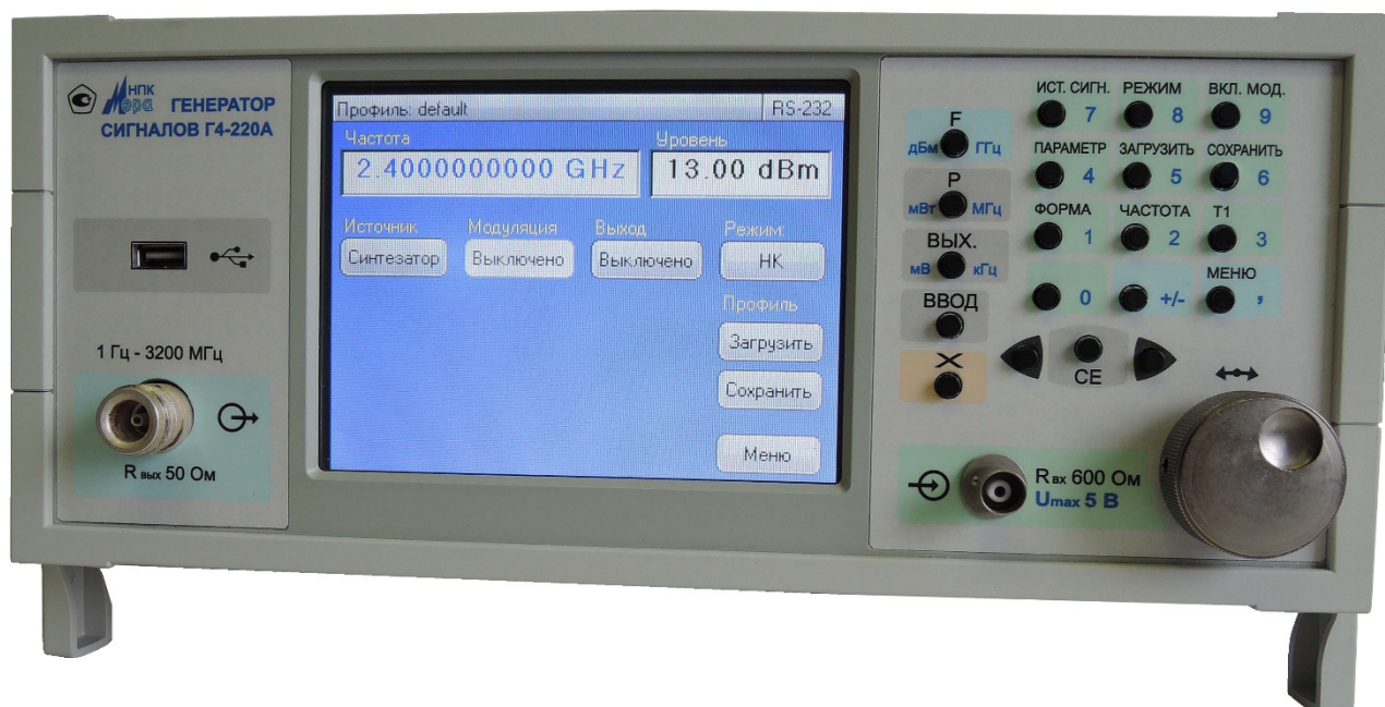
Рисунок 1 – Общий вид генератора
