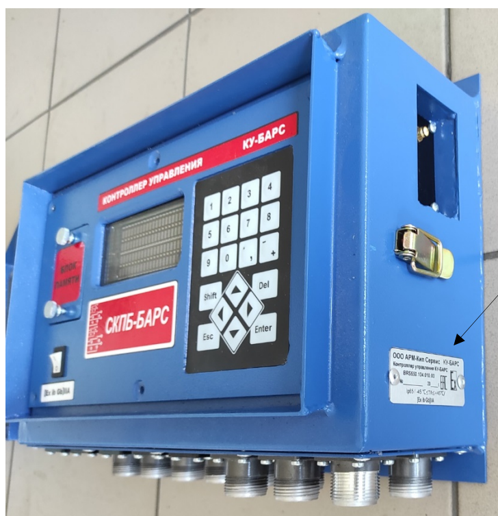
Рисунок 4 – Общий вид СКПБ-БАРС.
