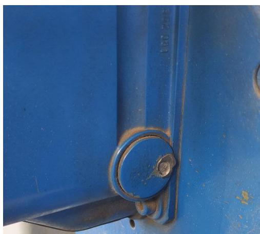
Рисунок 7 – Схема пломбировки крышки регулировочного винта счетчика
