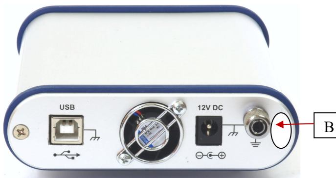
Рисунок 2 – Вид задней панели осциллографов и схема пломбировки от несанкционированного доступа (В)
