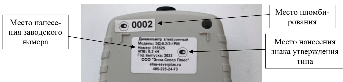
Рисунок 6 – Общий вид типовой идентификационной наклейки на электронном блоке и пример пломбировки от несанкционированного воздействия
