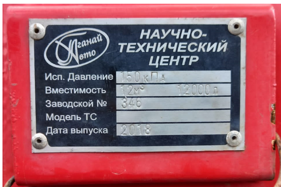
Рисунок 2 – Металлическая табличка с заводским номером автотопливозаправщика АТЗ-12
