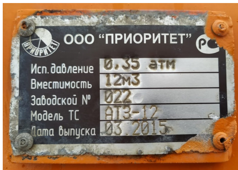
Рисунок 3 – Табличка с заводским номером автотопливозаправщика АТЗ-12
