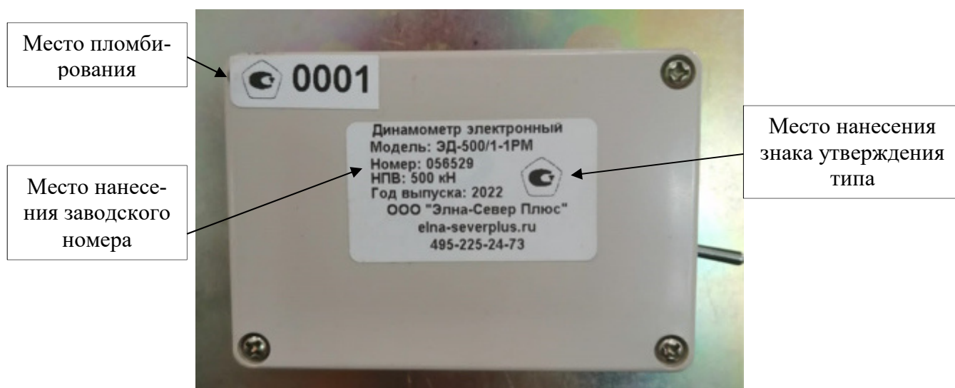
Рисунок 5 – Общий вид типовой идентификационной наклейки на датчике и пример пломбировки от несанкционированного воздействия
