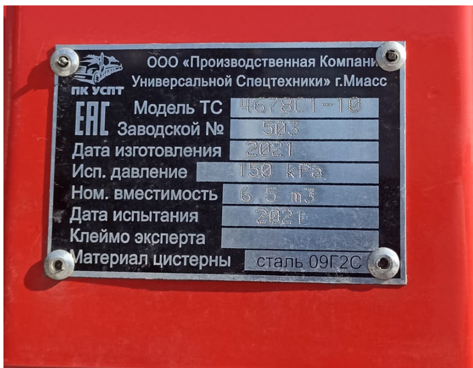
Рисунок 3 – Табличка с заводским номером автотопливозаправщика АТЗ-6,5
