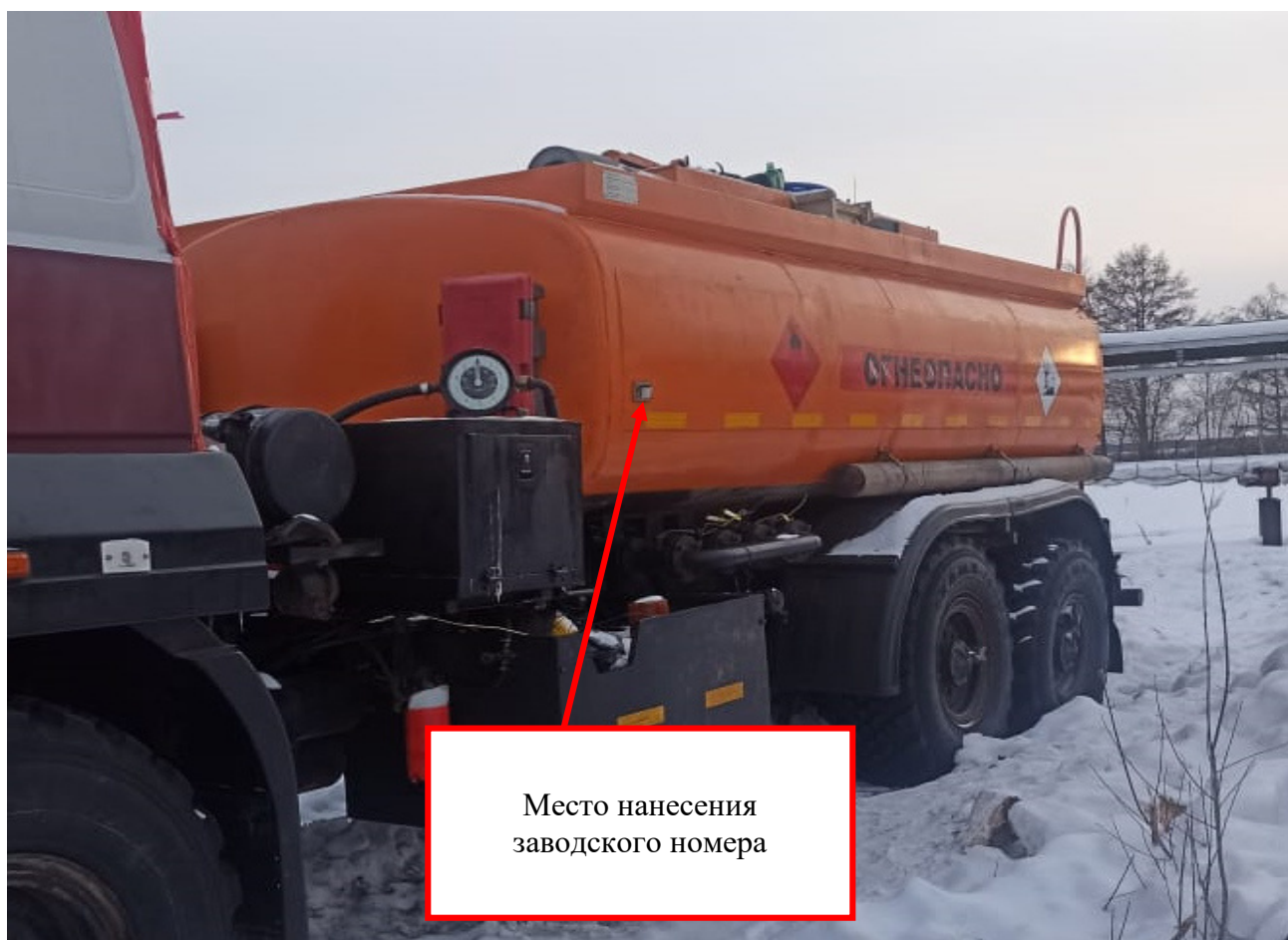
Рисунок 2 – Место нанесения заводского номера автотопливозаправщика АТЗ-12
