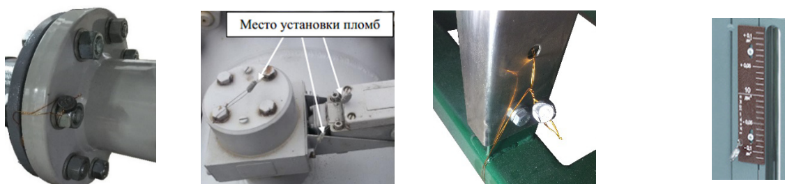
Рисунок 3 – Схемы пломбирования от несанкционированного доступа, обозначение мест нанесения знака поверки на фланцевые соединения расходомеров и/или ТПУ, детекторов ТПУ, и/или места установки (крепления) мерников к основанию (общей раме) установки, регулируемые шкалы (при наличии) мерников ( в зависимости от состава) установок поверочных автоматизированных УПРС+
