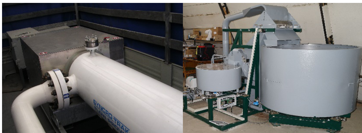
Рисунок 2 – Общий вид установок поверочных автоматизированных УПРС+
