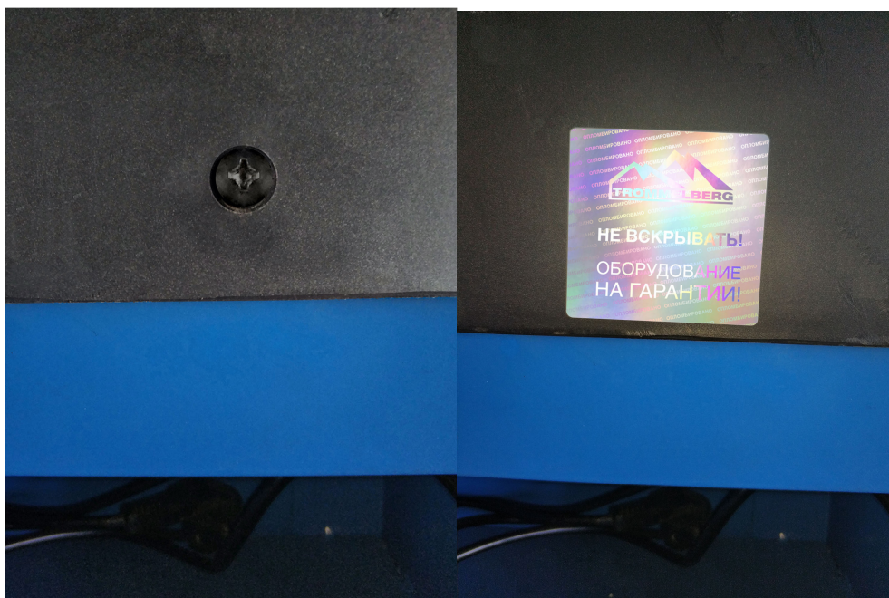
Рисунок 6 – Место нанесения пломбирующей наклейки
