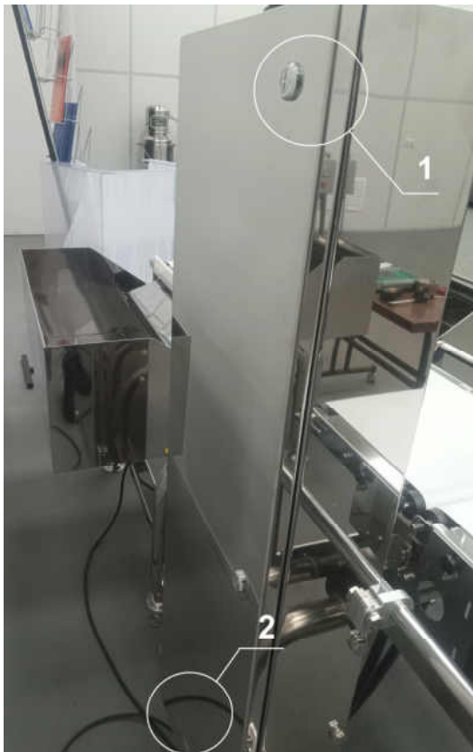
Рисунок 2 – Место пломбирования (1), место нанесения маркировочной таблички (2) со знаком поверки, знаком утверждения типа, заводским номером
