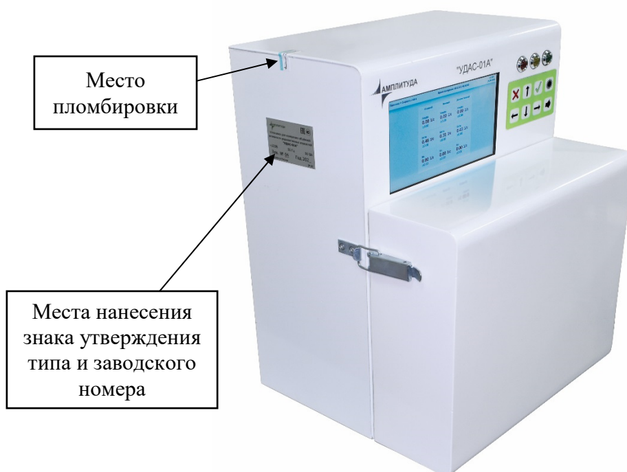
Рисунок 1 – Общий вид установки с местами пломбировки, нанесения знака утверждения типа и заводского номера
