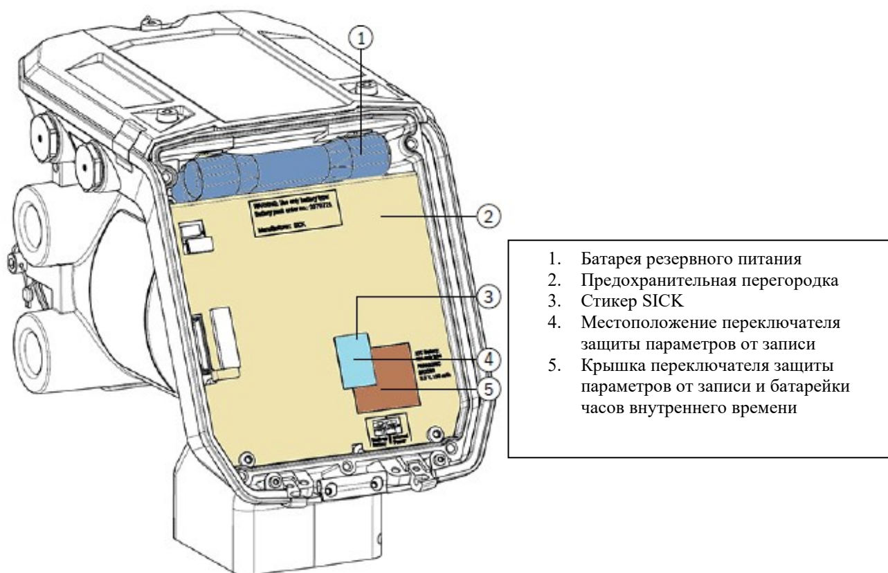
Рисунок 6 – Переключатель защиты параметров от записи
