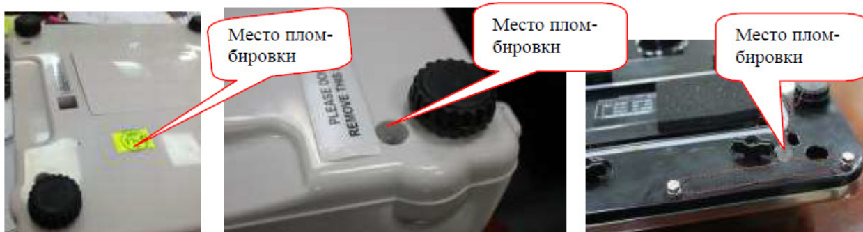
Рисунок 6 - Место пломбировки от несанкционированного доступа весов CS2010
