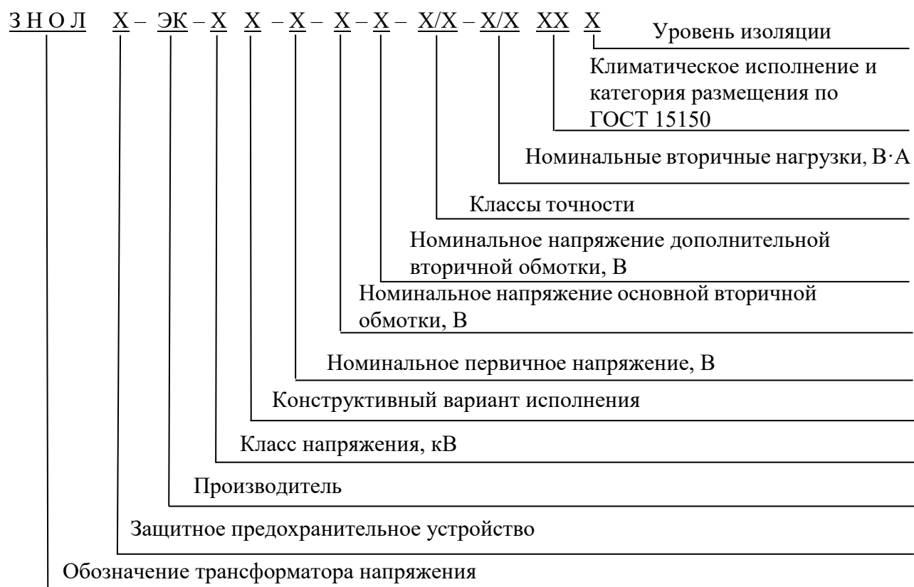
Рисунок 1 – Расшифровка условного обозначения трансформаторов напряжения
