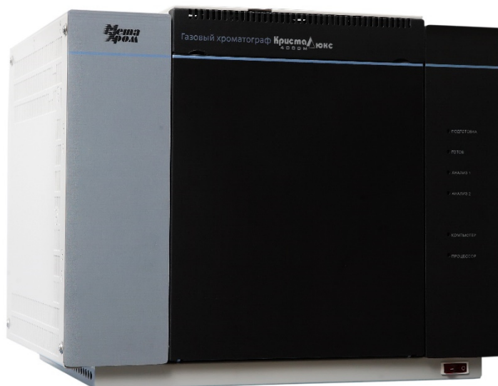
Рисунок 1 – Общий вид хроматографа аналитического газового «Криссталлюкс-4000М» Заводской номер наносится типографским способом в числовом формате на табличку, расположенную на задней панели составных частей хроматографа.
