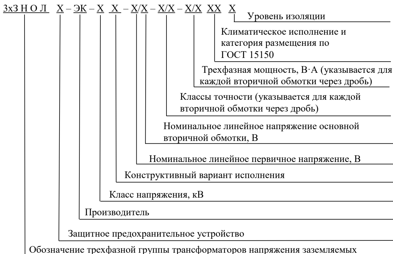
Рисунок 2 – Расшифровка условного обозначения трансформаторов напряжения, собранных в трехфазную группу
