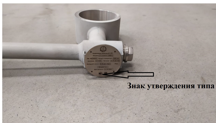
Рисунок 2 – Схема пломбировки от несанкционированного доступа, обозначение мест для нанесения знака поверки и знака утверждения типа
