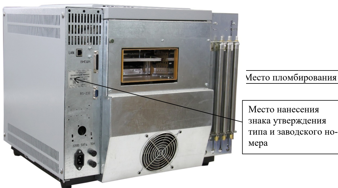
Рисунок 2 – Схема пломбировки от несанкционированного доступа и место нанесения знака утверждения типа и заводского номера
