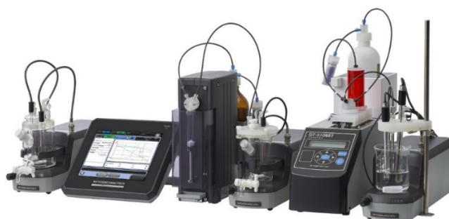
Рисунок 5 – Общий вид титратора GT-310, предназначенного для одновременного потенциометрического титрования (единичная проба), волюмометрического титрования по Карлу Фишеру и кулонометрического титрования по Карлу Фишеру в комплектации: мультиконтроллер CA-310MC, блок потенциометрического титрования GT-310STR, бюретка GT-310BRT, два блока титрования по Карлу Фишеру CA-310STR и бюретка CA-310BRT
