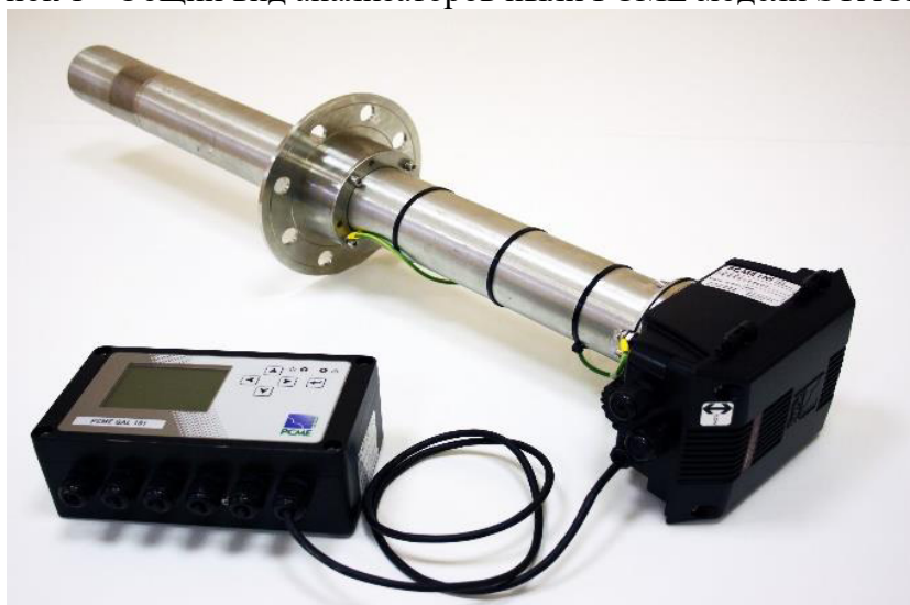
Рисунок 2 - Общий вид анализаторов пыли PCME модели QAL 181
