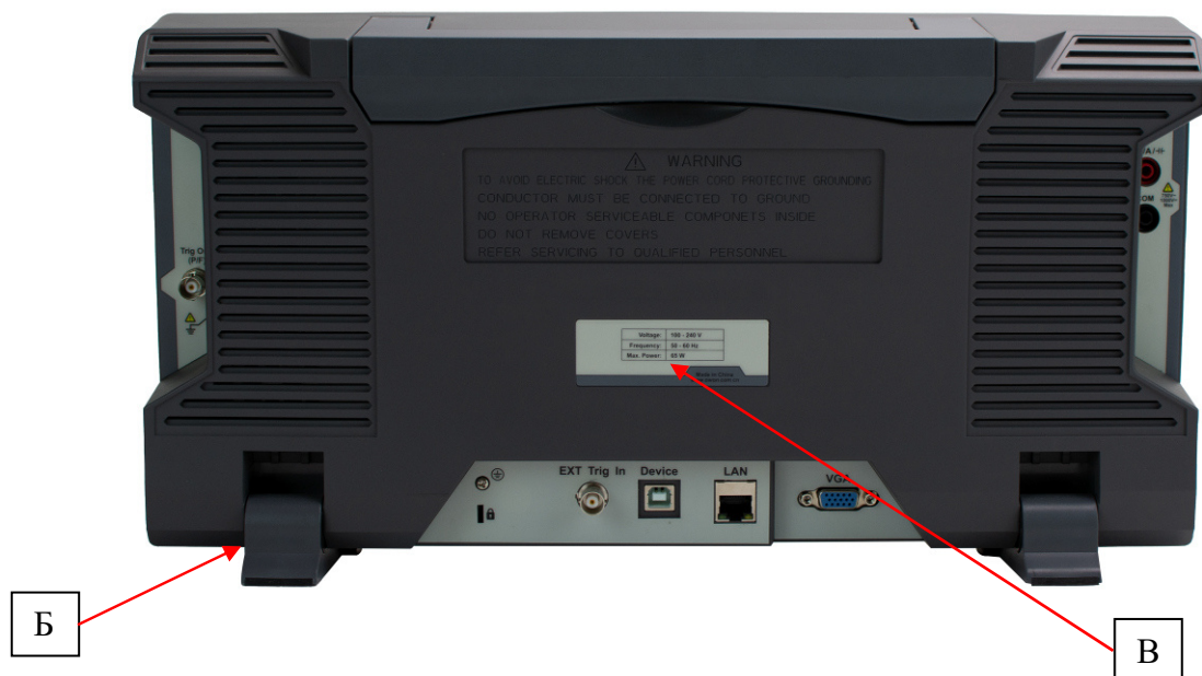
Рисунок 2 – Схема пломбировки от несанкционированного доступа (Б) и место нанесения серийного номера (В)
