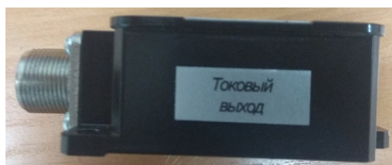
Рисунок 2 – Маркировка типа выходного сигнала преобразователей виброперемещений ИВП
