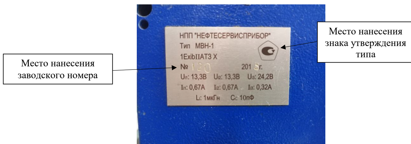
Рисунок 4 – Места нанесения заводского номера и знака утверждения типа на первичный преобразователь
