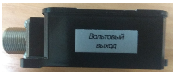
Рисунок 2 – Маркировка типа выходного сигнала преобразователей виброперемещений ИВП
