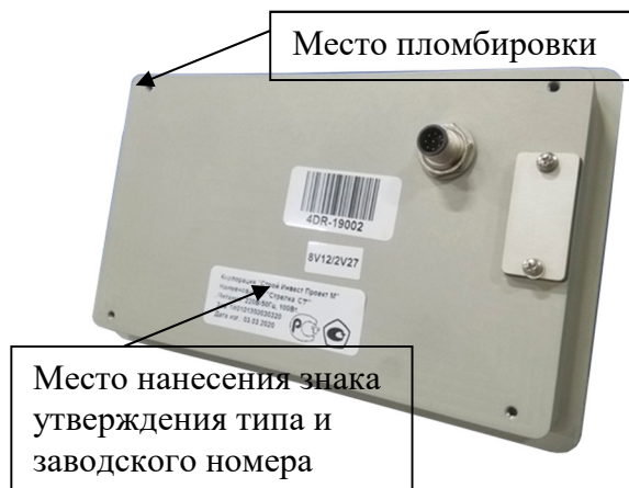
Рисунок 6 – Схема пломбировки и место нанесения знака утверждения типа и заводского номера на 4D модуль
