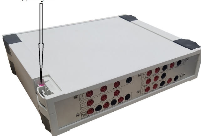
Рисунок 5 - Место пломбирования от несанкционированного доступа
