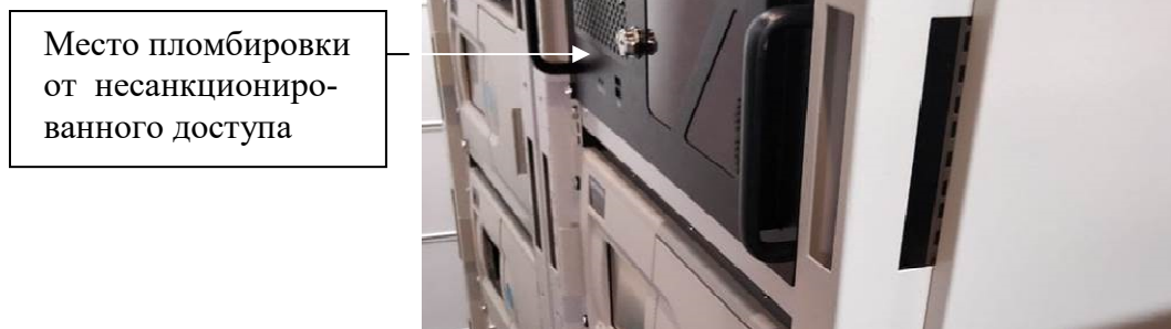
Рисунок 3 - Схема пломбировки от несанкционированного доступа (системный блок компьютера)
