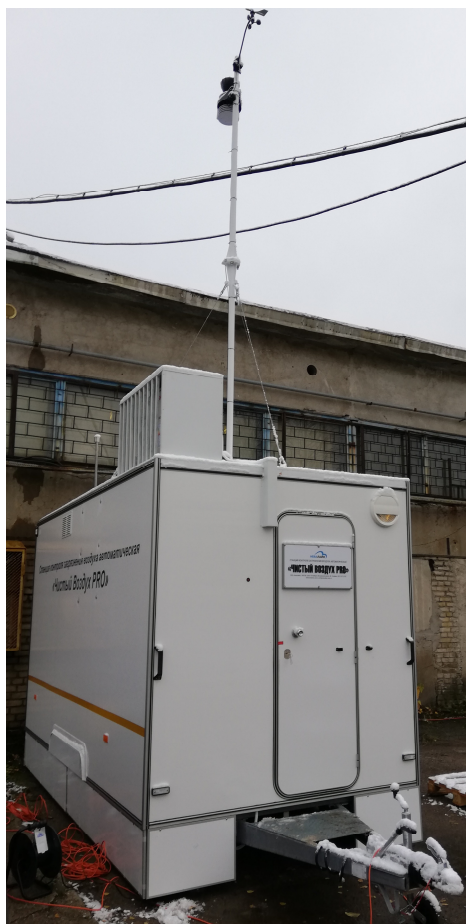
Рисунок 1 – Общий вид станции контроля загрязнения атмосферного воздуха автоматической «Чистый воздух PRO» (стационарное исполнение, вид снаружи и внутри станции)
