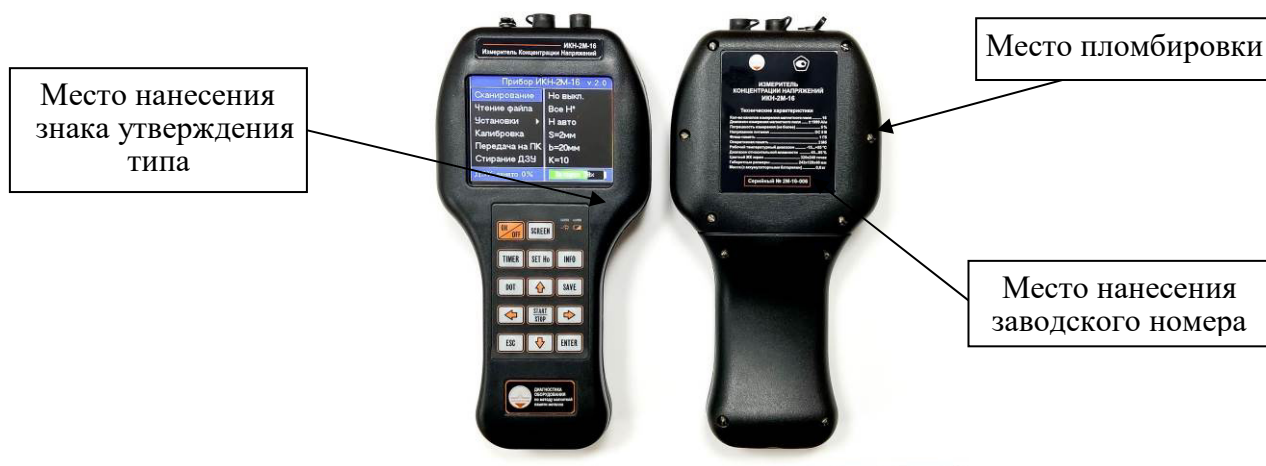
Рисунок 1 – Общий вид прибора модификации ИКН-2М-16, обозначение мест нанесения знака утверждения типа, пломбировки и нанесения заводского номера
