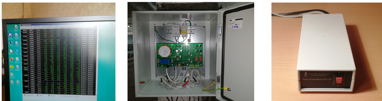
Рисунок 1 – Общий вид среднего уровня: контроллер БЦ-16 в герметичном коробе и устанавливаемая внутри измерительная плата с установленными компонентами
