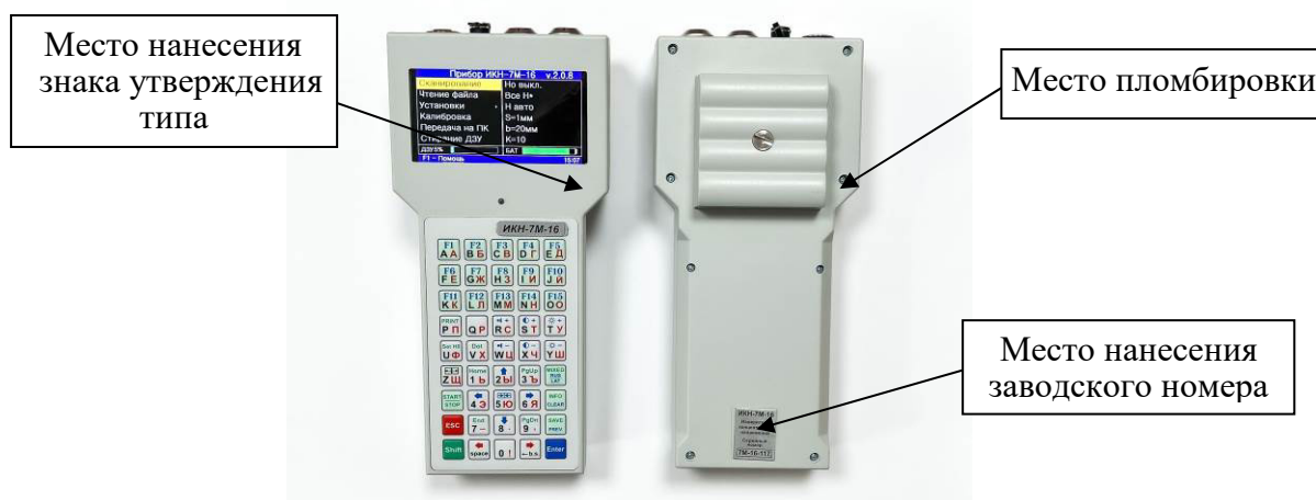
Рисунок 2 – Общий вид прибора модификации ИКН-7М-16, обозначение мест нанесения знака утверждения типа, пломбировки и нанесения заводского номера
