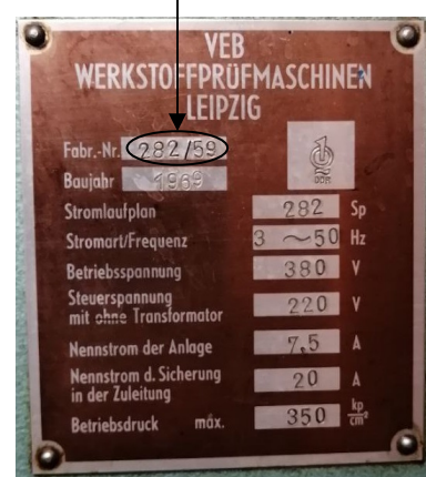
Р и с у н о к 2 – Общий вид машины ЦД-40 с заводским номером 282/59 и маркировочной таблички с указанием места нанесения заводского номера
