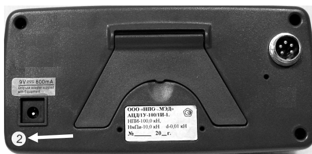
Рисунок 18 - Пример пломбировки от несанкционированного доступа (Пломбирующая наклейка указана стрелкой)
