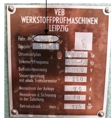
Р и с у н о к 1 – Общий вид машины ЦД-10 с заводским номером 280/23 и маркировочной таблички с указанием места нанесения заводского номера
