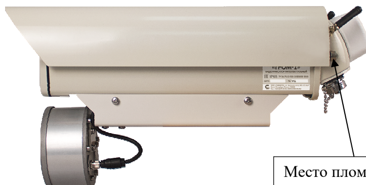
Рисунок 3 – Место пломбировки от несанкционированного доступа видеорегистратора интеллектуального «ГРОМ-1»
