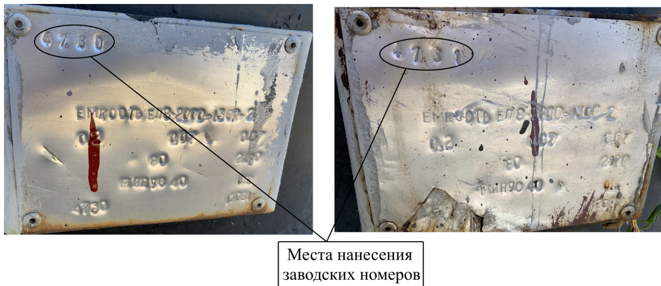
Рисунок 1 – Маркировочные таблички резервуаров
