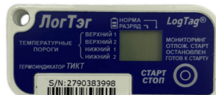
Рисунок 3 – Общий вид измерителей модели ТИКТ (TICT)
