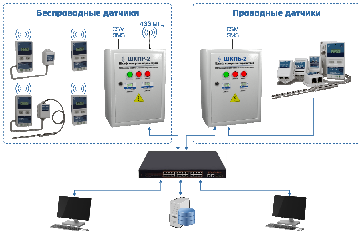
Рисунок 1 – принципиальная схема систем мониторинга микроклимата ГИГРОТЕРМОН
