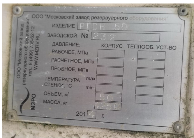
Рисунок 3 – Общий вид маркировочной таблички резервуара
