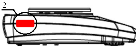
Рисунок 2 – Место нанесения заводского номера, знака поверки, знака утверждения типа (1); место пломбировки от несанкционированного доступа: разрушаемая наклейка (2).
