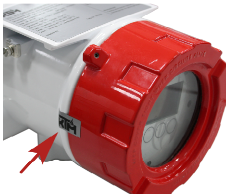
Рисунок 2 – Схема опломбирования УЗС-1М
